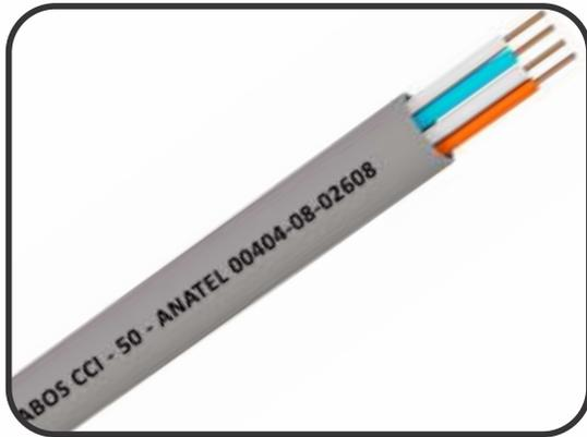
**Características:** Condutores de cobre eletrolítico estanhado, isolados com cloreto de polivinila, binados e agrupados. Cobertura externa em PVC na cor cinza.
